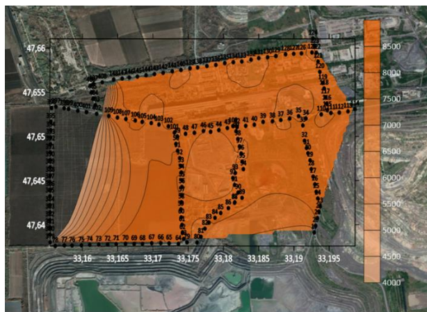
Рис. 2. Карта-схема зон міграції підземних вод за результатами площинної інтерпретації амплітудних характеристик в частотному діапазоні 7-50кГц
