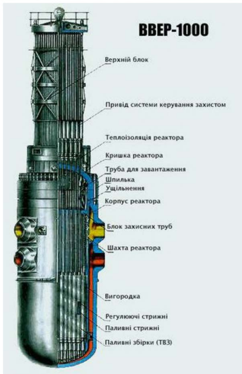
Рис. 2.8.1. Конструкція реактора ВВЕР
